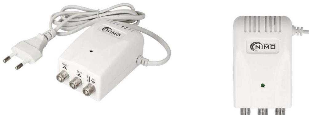
Fuente conmutada de bajo consumo y alto rendimiento, esta fuente permite la alimentación a través del cable coaxial, de amplificadores de mástil e incorpora un repartidor para que la señal que llega desde el amplificador se pueda distribuir a distintos puntos de la instalación.
